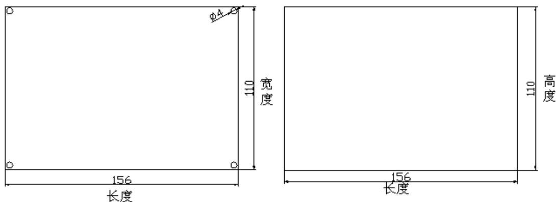
可以采用平底导轨或螺栓固定方式安装。
